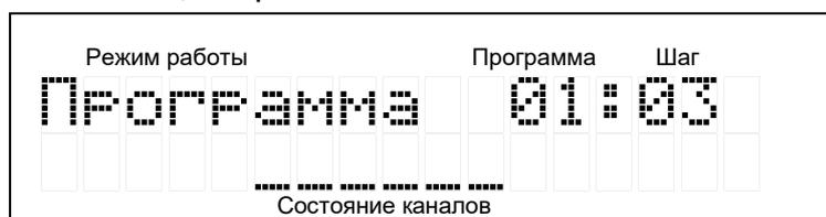
В этом режиме существует возможность вмешиваться в ход выполнения программы. Если сдвинуть один из регуляторов каналов <6> то соответствующий канал примет состояние регулятора и не будет более зависеть от программы. При этом на индикаторе появится
