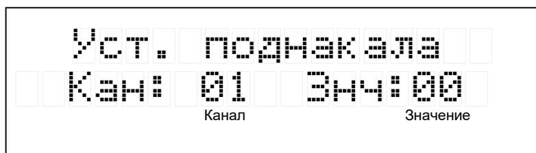
Кнопки <◀> и <▶> устанавливают канал, а <▲> и <▼> изменяют значение поднакала для него. Ключевое слово "Все" позволяет производить настройку для всех каналов одновременно. Нажатие кнопки <Enter> приводит к запоминанию установленных значений. Кнопка <Menu> позволяет отказаться от изменений.
