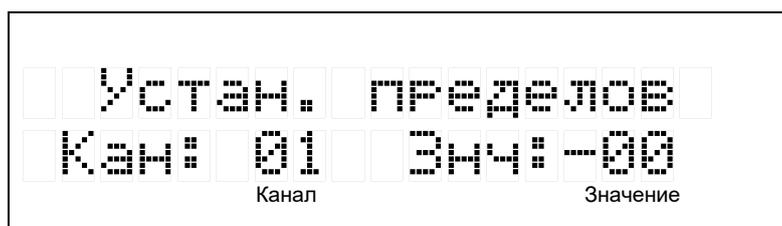
Кнопки <◀> и <▶> устанавливают канал, а <▲> и <▼> изменяют значение предела для него. Ключевое слово "Все" позволяет производить настройку для всех каналов одновременно. Нажатие кнопки <Enter> приводит к запоминанию установленных значений. Кнопка <Menu> позволяет отказаться от изменений.
