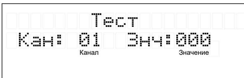
Кнопки <◀> и <▶> устанавливают канал, а <▲> и <▼> изменяют значение для него. Ключевое слово “Все” позволяет производить управление всеми каналами одновременно. Нажатие кнопок <Enter> или <Menu> позволяет выйти из режима.
